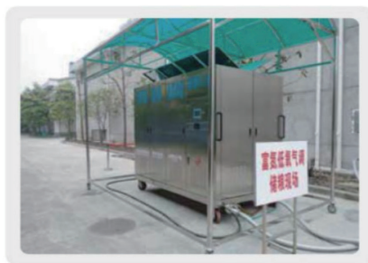
膜分离氮气循环气调储粮现场图
